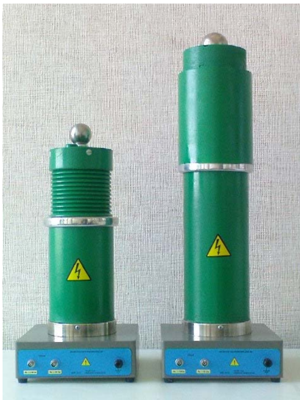
Фото 1. Импульсные высоковольтные делители напряжения на 40 и 80 kV.
