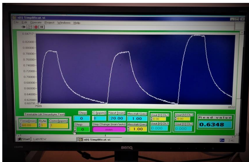
Fig. 2.15. Reprezentarea grafică în timp real a variației curentului continuu, care trecea prin mostra experimentală
