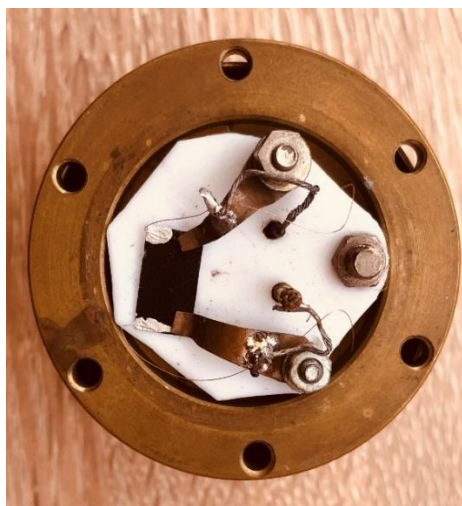
Fig. 2.8. Imaginea mostrei experimentale de film flexibil, bazat pe nanocompozitul Te-SnO_2 , montat în scaunul de testare [65]
