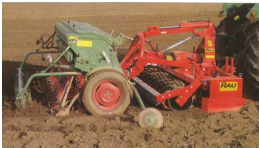
Fig. 3.24. Agregat combinat pentru pregătirea patului germinativ și semănat, în teren arat, de tip RAU, Germania (două treceri a agregatului pe teren).
