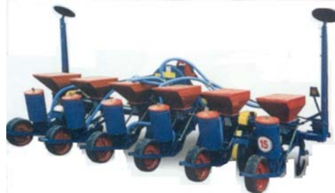
Fig. 3.22. Semanatoare combinată, pentru plante prasitoare, de tip SPC (SPC-6) fabricată la Mecanica „Ceahlău” S.A. Piatra Neamț.
