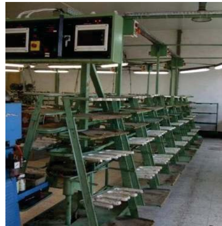
Fig. 5. Bandă transportoare închisă în plan orizontal, cu ritm impus, cu comandă electronică [8]
