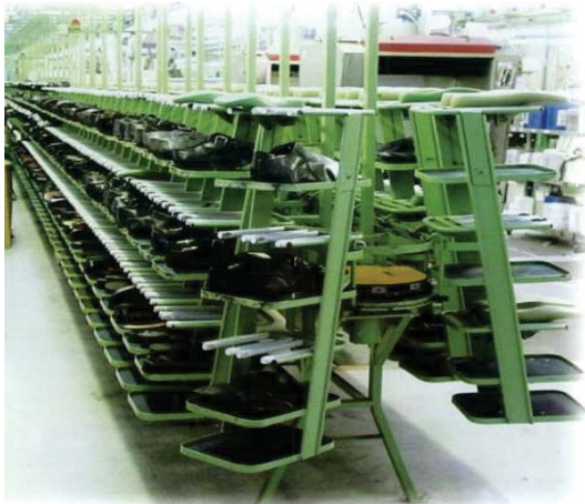
Fig. 4. Bandă transportoare închisă în plan orizontal, cu ritm impus, cu patru nivele [7]
