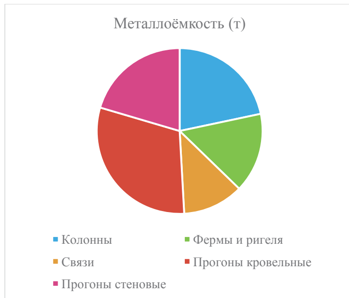
Рис. 1Metalloёмкость элементов металлического каркаса здания 18x48м
