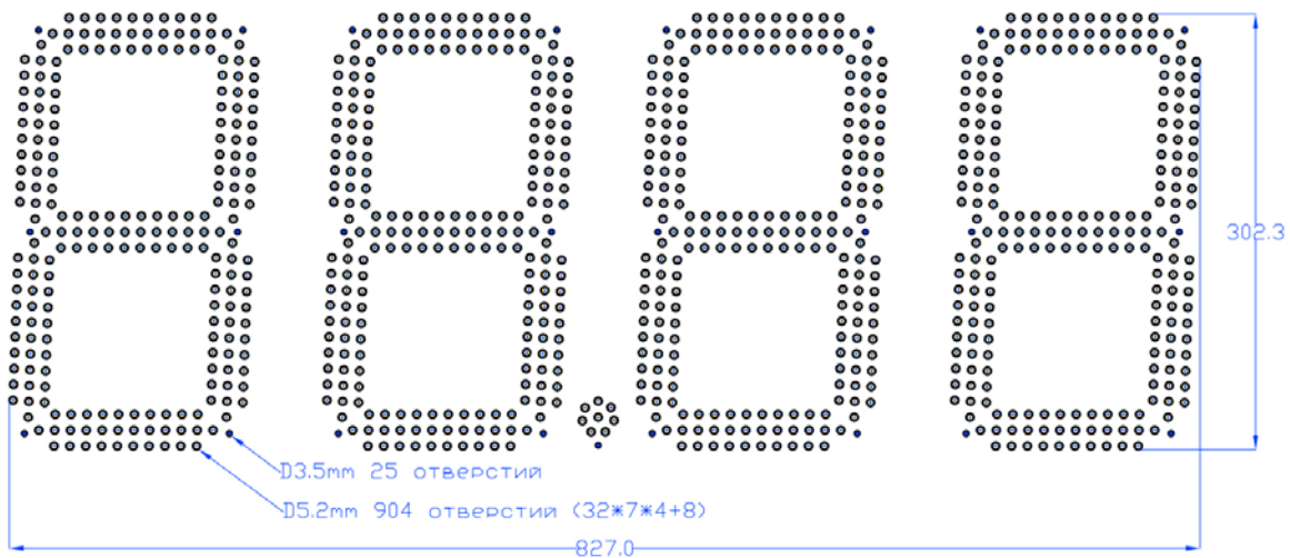
Рис.2 Конструктивный вид светодиодного рекламного панно.
