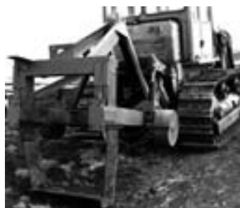
Fig. 15. Mașinile utilizate pentru desfundare a solului în livezile superintensive de măr: a. – cu ajutorul scarificatorului; b. – cu ajutorul scoabei speciale.
