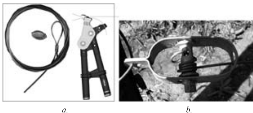
Fig. 50. Utilaje pentru întinderea sârmei: a – sistemul „Gripple”; b. – scripete cu clichet.
