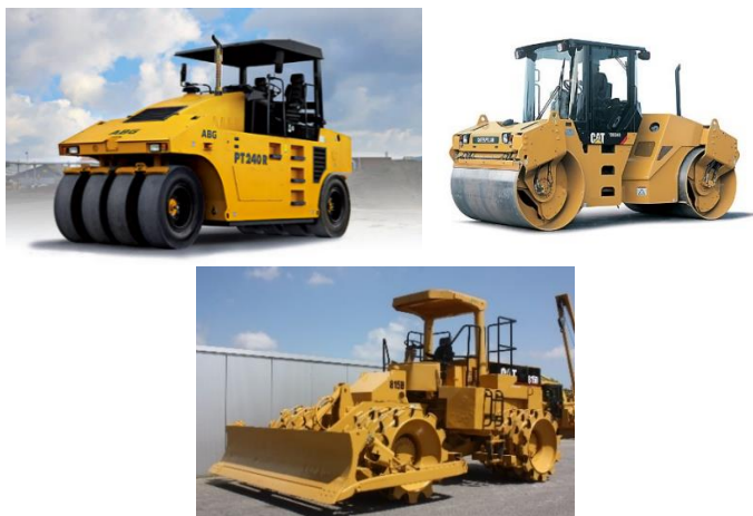
Fig. 2.1. Exemple de utilaje care realizează compactarea prin acțiune statică asupra terenului
