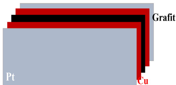
Figura 2. Un electrod compus grafit-Cu-Pt.
