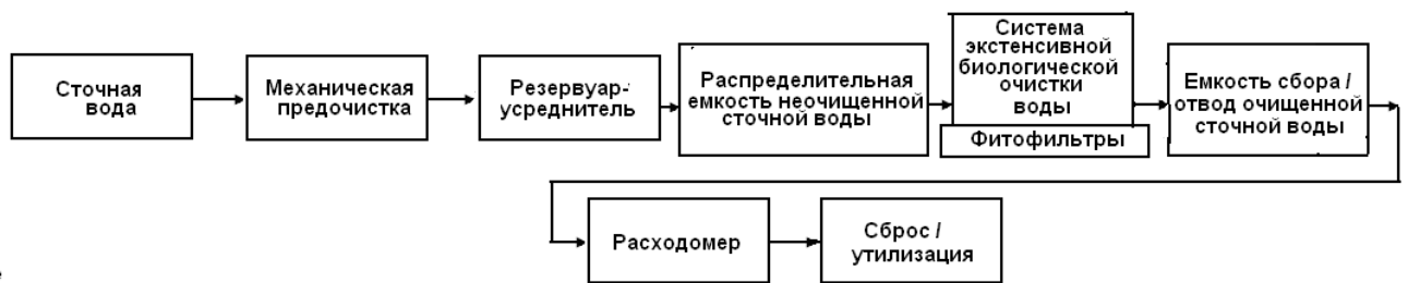
Рис.2. Технологическая схема экстенсивной биологической очистки сточных вод в фитофильтрах (фильтрах, засаженных макрофитами)
