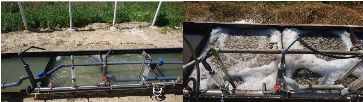
Fig. 2.3. Instalația-pilot de epurare a apelor uzate asupra căreia au avut loc experimentele
