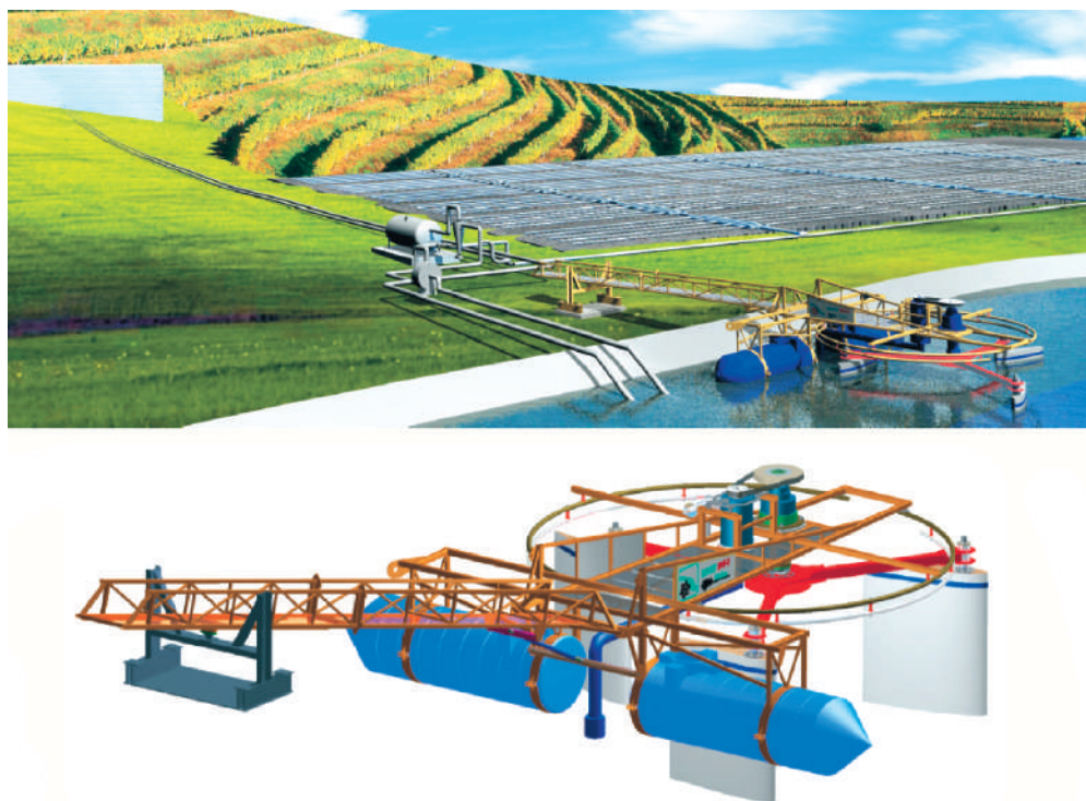
Fig. 2.106. Sistem de irigare prin picurare alimentat cu energie electrică produsă de turbina eoliană
