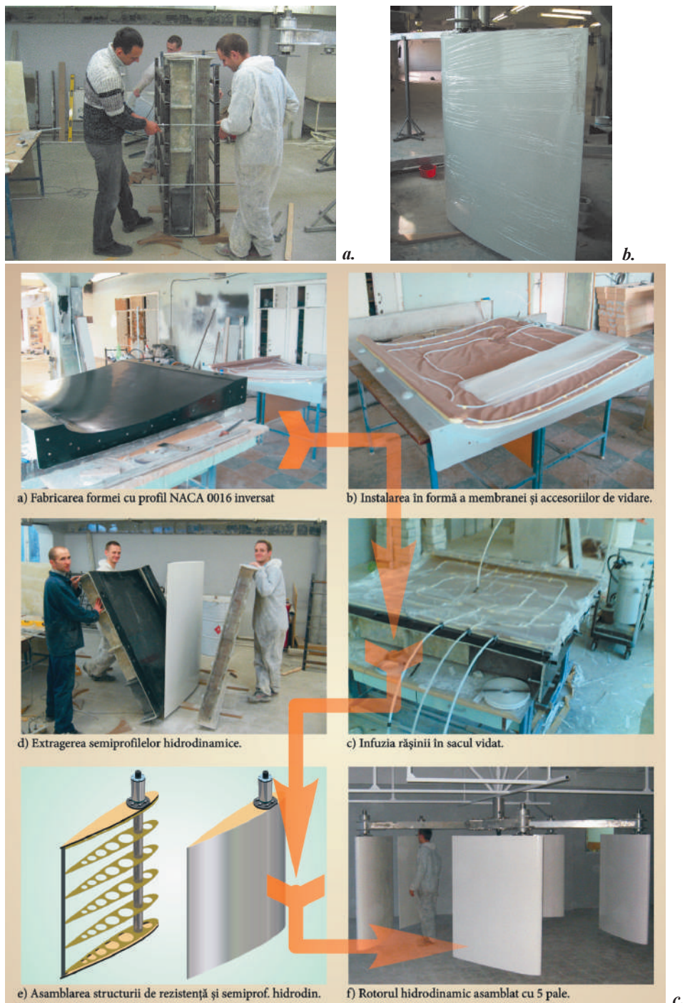
Fig. 2.80. Proces tehnologic de fabricare a paletelor în înveliș din materiale compozite.
