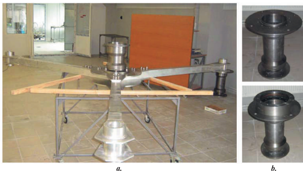
Fig. 2.85. Construcția nodului cu rulmenți a rotorului hidrodinamic (a) și mostrele nodului fabricate la întreprinderea REUPIES, SRL, Chișinău.
