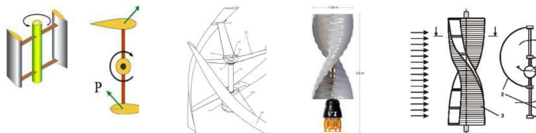
Fig. 3. TE Savonius cu pale din benzi suprapuse a), b); TE Darrieus: c) concept structură d) principiu de lucru (P-portanța).
