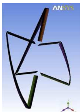
Fig. 7. Concept 3D SW: a) Discretizarea în elemente finite a rotorului proiectat (modulul CFX-Mesh) b) Darrieus, c) Savonius A Rezultatele calculului CFD de modelare a interacțiunii TE-C cu fluxul de aer
